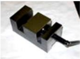
実習で制作したミニバイス。直行度、平行度と加工の基本を体験しました。
